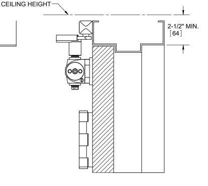
DOOR CLOSER MODELS: 8616 SISH REGULAR INSTALLATION (PULL SIDE MOUNT) WITH BACK PLATES BP86 & BP86FC SPRING INTEGRA CUSHION ARM
